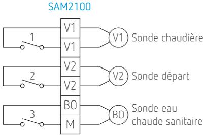
Si le contact 2 est fermé, la vanne mélangeuse se referme impérativement. Exemples :
